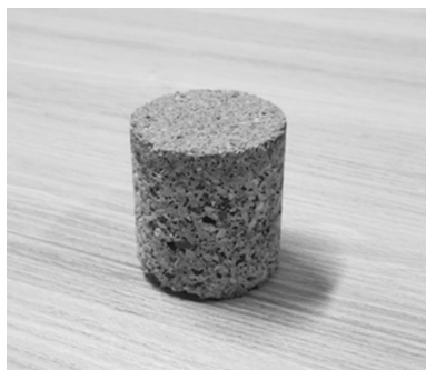
图1 透水砖圆柱芯样(截取自实际试样)
