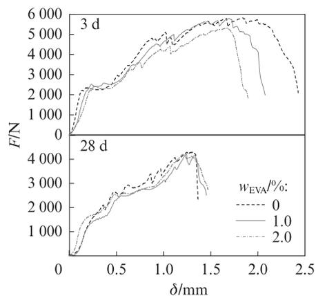
图1 EVA乳液对高韧性防水砂浆弯曲荷载-位移 ( $F-\delta$ ) 曲线的影响
