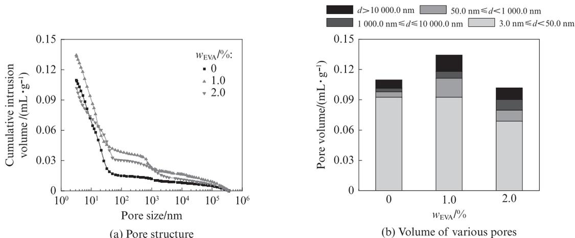
图5 EVA乳液对高韧性防水砂浆孔结构的影响
