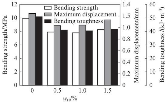
图7 硅烷乳液对高韧性防水砂浆弯曲性能的影响
