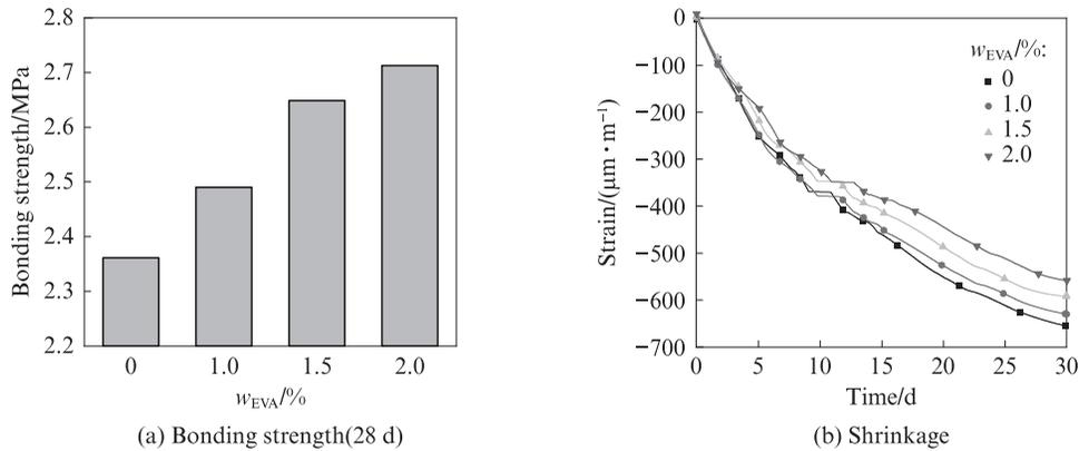
图 2 EVA 乳液对高韧性防水砂浆的界面黏结强度和收缩的影响
