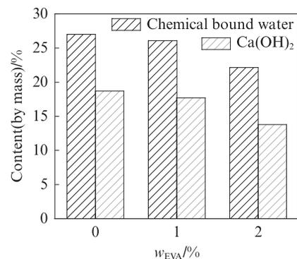
图 4 EVA 乳液对硬化水泥浆的化学结合水和  $\text{Ca}(\text{OH})_2$  含量的影响
