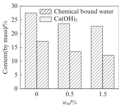
图10 硅烷乳液对硬化水泥浆的化学结合水和Ca(OH)<sub>2</sub>含量的影响
