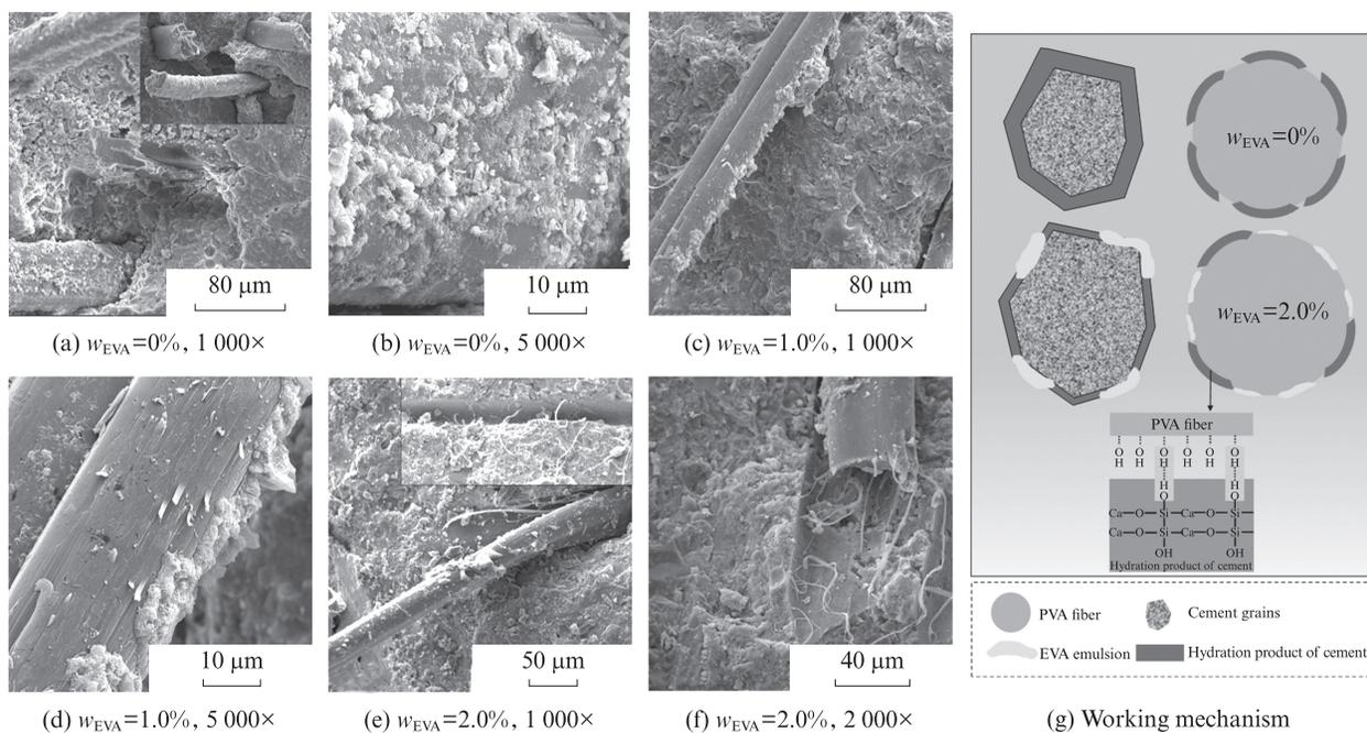
图6 EVA乳液对高韧性防水砂浆微观形貌的影响及作用机理示意图
