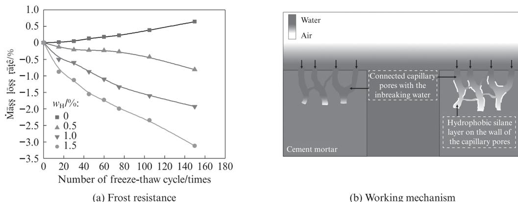
图9 硅烷乳液对高韧性防水砂浆抗冻性的影响与作用机理示意图
