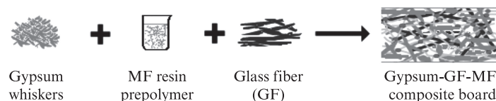
图1 密胺树脂强化脱硫石膏复合材料的过程图示
